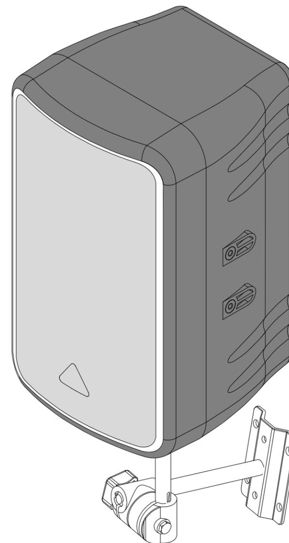
**1** ロッドの一つをスピーカー・マウント・プレートの六角形のソケットに挿入します。同梱されているボルトの一つをマウンティング・プレートに通し、ロッドにねじ入れます。
