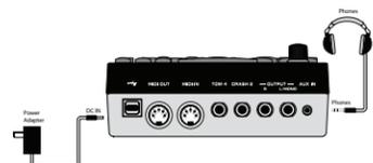
4. パワーサプライ・アダプターを電源に接続します。本製品はユニバーサル・アダプターで、主電圧 100 ボルト ~240 ボルトに対応します。DC 出力端子をドラム・モジュールに接続します。
